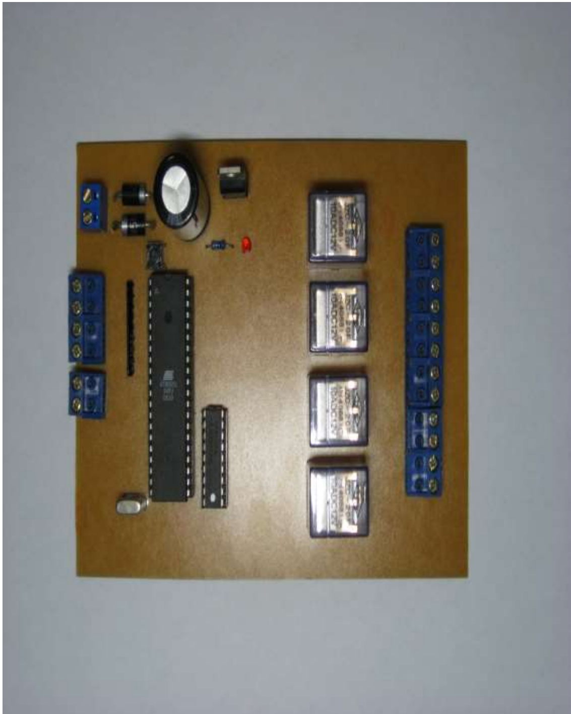
( Gambar 3.3 Rangkaian sistem kunci pengaman menggunakan mikrokontroler )
